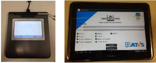
Figura 2: Dispositivos de captura empleados en este estudio para adquirir firmas dinámicas. Izquierda Wacom STU-530, derecha Samsung Galaxy Note 10.1.
